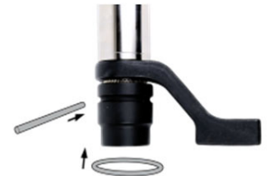
ABBILDUNG 16 – Befestigen des Einsatzes
