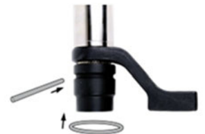
ABBILDUNG 18 – Befestigen des Einsatzes
