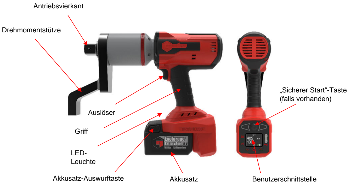
ABBILDUNG 1 – Werkzeugbestandteile
